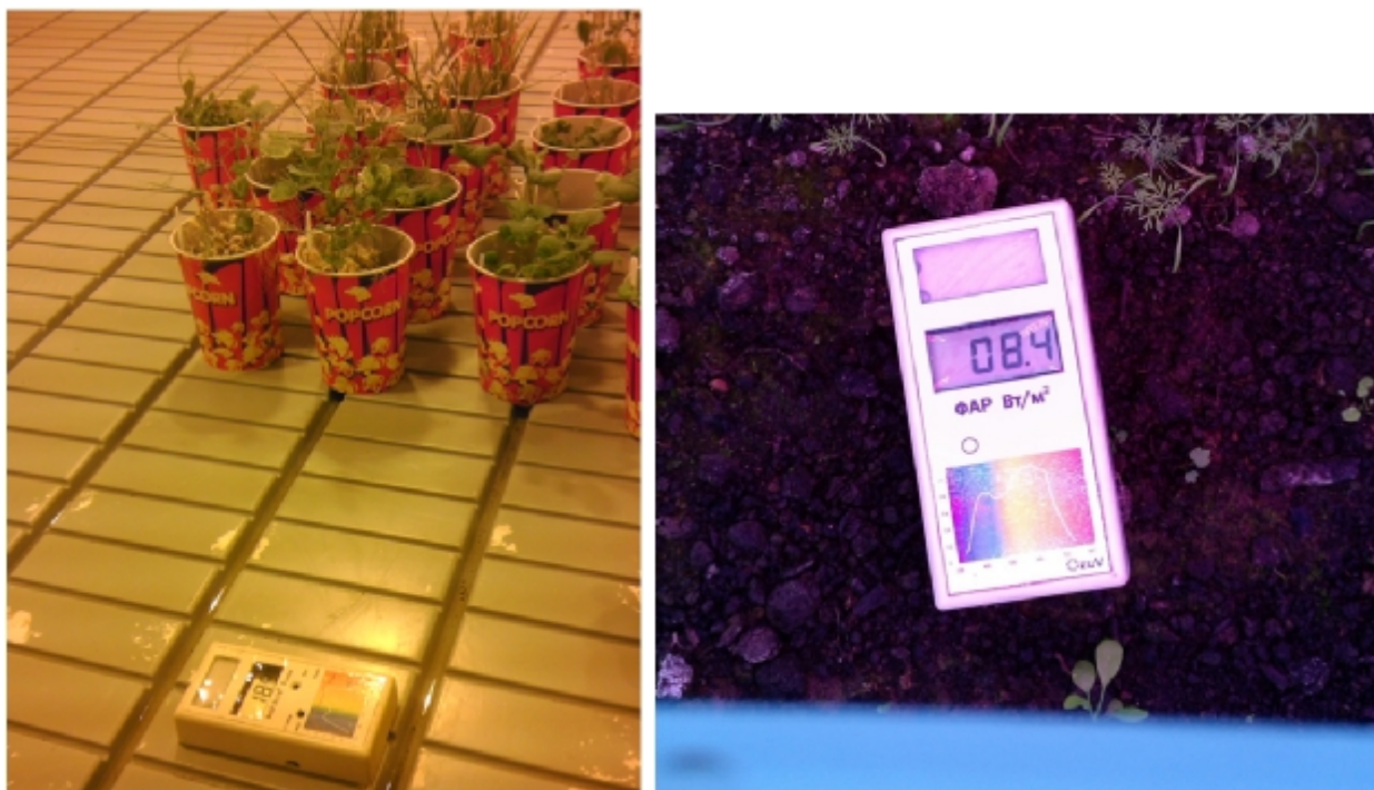
Рисунок 4.1 Измерение мощности излучения различных источников: слева натриевая лампа высокого давления 600Вт, справа светодиодная матрица 100Вт
