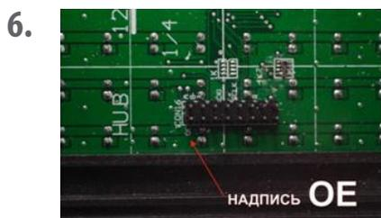
Соединить модули между собой межмодульным кабелем, соблюдая (ОЧЕНЬ ВАЖНО) правильную ориентацию. На кабеле есть специальная ориентационная жила красного цвета, совмещённая со стрелочкой на чёрном (сером) разъёме прикреплённым к кабелю. Это так называемая «первая жила» или «ключ». Разъём на модуль нужно устанавливать таким образом, что бы «ключ» совпадал с надписью «OE» около разъёма на плате модуля.
