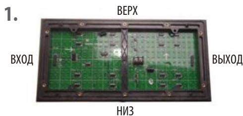
Раскладываем модули на ровной поверхности светодиодами вниз. Необходимо соблюдать правильную, одинаковую для всех модулей ориентацию. «Козырьки» над светодиодами должны быть направлены в одну сторону, все вертикальные стрелки в одну сторону, все горизонтальные стрелки в одну сторону. Вход бегущей строки (если смотреть с задней части) всегда находится слева, а если смотреть с лицевой, то справа. То есть, первым модулем (если смотреть с лица) является самый правый.
